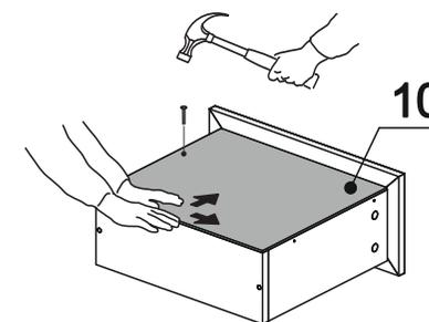
Для установки направляющих используйте регулировочные отверстия, а так же шуруп 3.5x16
