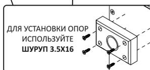
Для установки опор используйте шуруп 3.5x16
