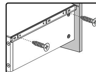
Для установки ручек на фасады ящика используйте винт 4x16 и пластиковую шайбу
