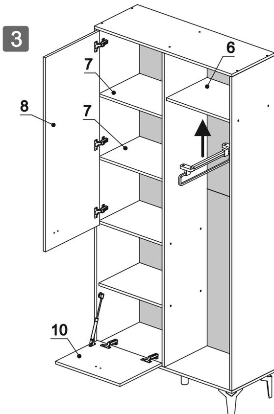
УСТАНОВИТЕ ГАЗ-ЛИФТ СОГЛАСНО ПРИЛАГАЕМОЙ К НЕМУ ИНСТРУКЦИИ ПО УСТАНОВКЕ
