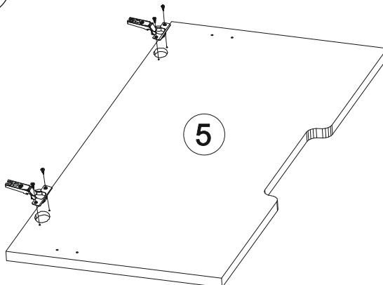
Регулирование зазоров и положения дверей с петлями
