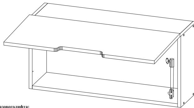
Схема установки газоголифта:
