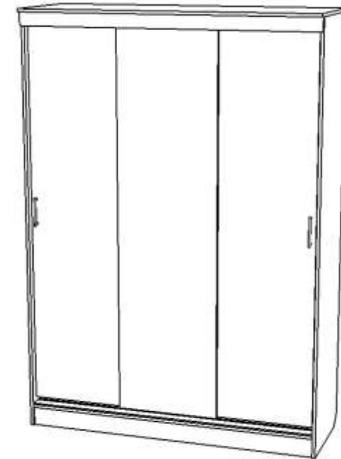
В готовые отверстия в боковинах 1,2 вставить полкодержатели и установить на них полки 9. С помощью шурупов прикрепить скалодержатели И установить на них скалку Собранные фасады подвесить на ходовой профиль роликами, вставив направляющую деталь (кораблик) в нижние направляющие канавки С помощью болта с шайбой прикрепить ручки, установить заглушки.
