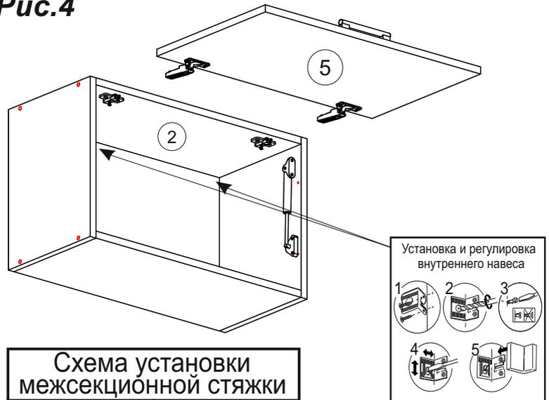
Схема установки межсекционной стяжки
