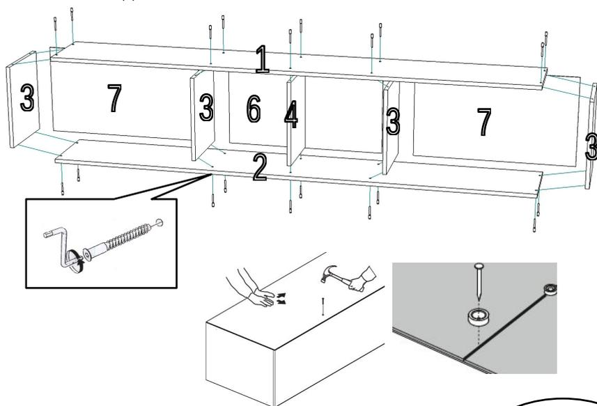
Для крепления секции используйте стяжки межсекционные (для установки секции между другими изделиями, шкаф и пенал, например). Для крепления секции на стену, используйте навесы угловые.
