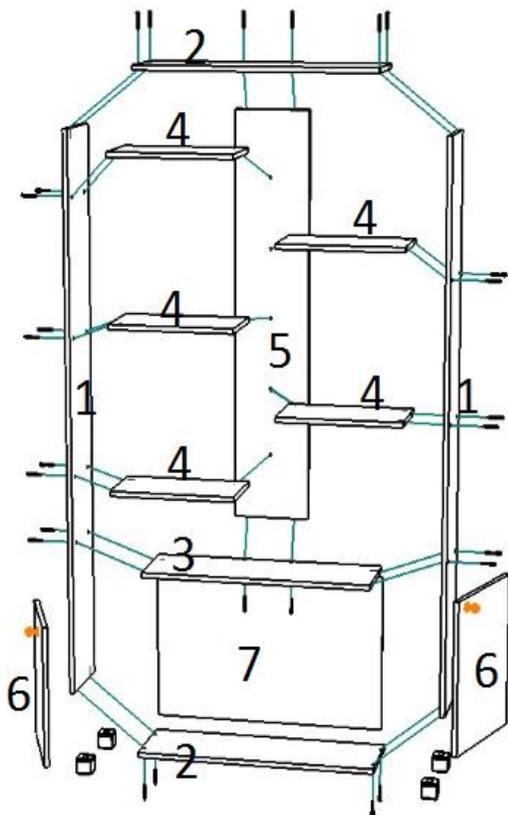
Шурупами 3,5\*16 привернуть опоры к детали 2. Скрепить еврошурупами и эксцентриками детали 1,2,3,4 и 5 как показано на рисунке. Гвоздями прибить ДВП.
