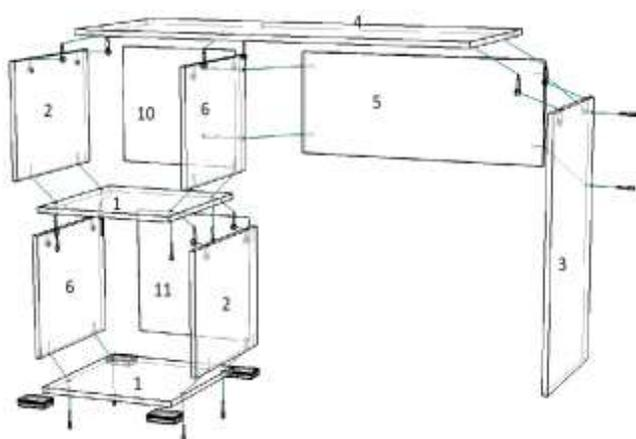
К детали 1 шурупами привернуть опоры 20 мм. Шурупами 3,5\*16 привернуть направляющие колесиком вперед к деталям 2 и 6. Прибить гвоздями подпятники к детали 3. С помощью еврошурупов и
