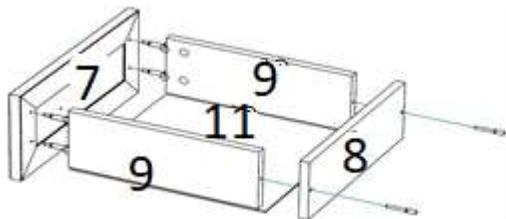
Еврошурупами скрепить детали 8 и 9, в пропил вставить ЛДВП 11. В готовые отверстия детали 7 вернуть эксцентрики и скрепить с деталью 9 замками. К нижней части ящика шурупами
