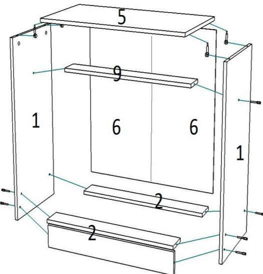
К полученной конструкции из деталей 1, 2, 9 прикрутить крышку 5 с помощью эксцентриковой стяжки
