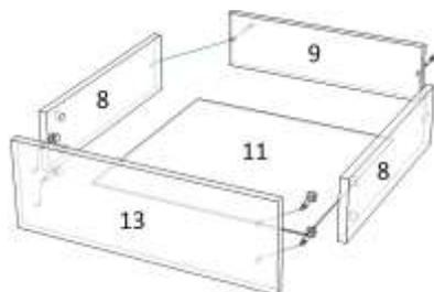
эксцентрики и стянуть замками с корпусом ящика. К нижней части ящика привернуть направляющие колесом назад.
