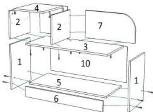
В готовые отверстия в деталях 3 и 4 ввернуть эксцентрики. К крышке 3 еврошурупами привернуть детали 2 и 7 установить крышку 4 и стянуть замками. Собранный конструкцию установить на корпус тумбы и стянуть замками эксцентриков.
