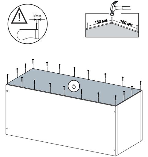
**ВАЖНО!!!** Измерьте диагонали собранного каркаса. Они должны быть равными (+/-1,2мм). Только после этого можете закрепить заднюю стенку ЛДВП при помощи гвоздей!
