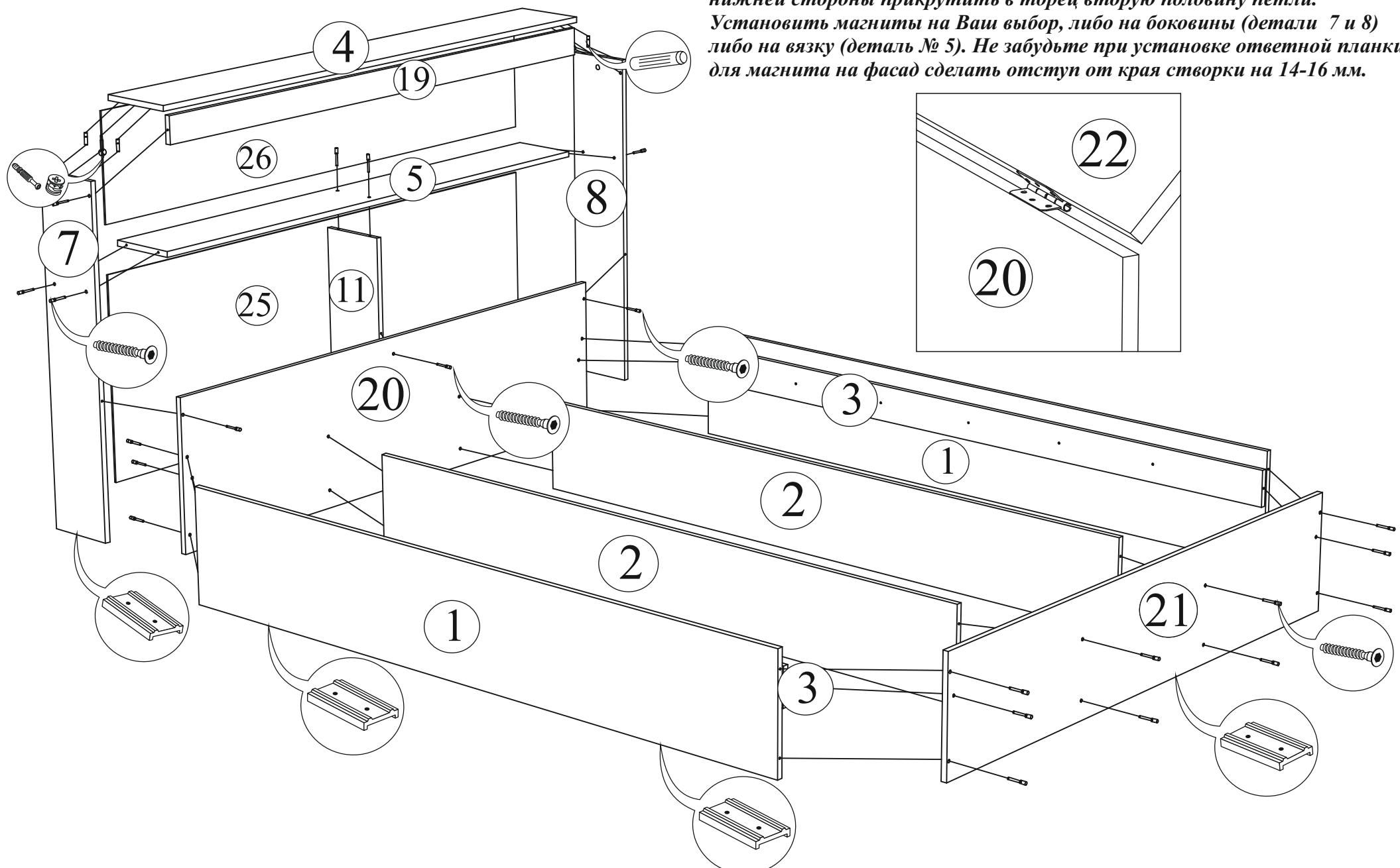
Установить фасад (деталь № 22) на трельяжные петли с помощью саморезов 3,5x16 (черные). Для этого необходимо сначала прикрутить трельяжные петли к торцам головного щитка (деталь № 20) на расстоянии 150 мм от боковин (детали № 7 и 8). Приложить фасад и с нижней стороны прикрутить в торец вторую половину петли.
