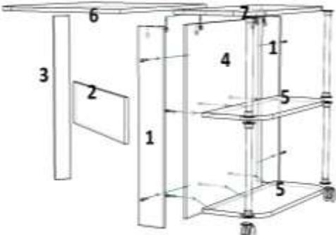
Гвоздями прибить подпятники к детали 1 и 3. К детали 5 и 7 привернуть фланцы в намеченные отверстия. Ввернуть эксцентрики в готовые отверстия детали 7. Скрепить детали 1,4,5 и 7 с помощью еврошурупов и эксцентриков стягивая замками как показано на рисунке (*установливая джокерные трубы*). Скрепить еврошурупами детали 2 и 3, привернуть шурупами к детали 1 на петли оконные. С помощью шурупов 3,5\*16 и оконных петлей скрутить крышки 6 и 7. К детали 5 / низ/ привернуть колесную опору.
