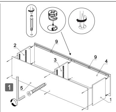
ПЛАНКИ №9 ЗАКРЕПИТЕ С ПОМОЩЬЮ ШУРУПОВ 3.5х30 К ЗАДНЕЙ ЧАСТИ КРЫШКИ ДЕТ.№4 (ПЛАНКИ ИСПОЛЬЗУЮТСЯ ДЛЯ КРЕПЛЕНИЯ ЛДВП)
