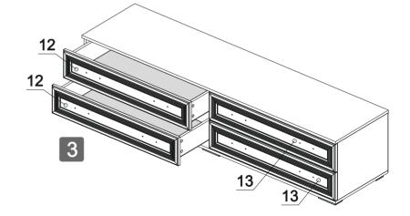
ДЛЯ УСТАНОВКИ РУЧЕК НА ФАСАДЫ ЯЩИКА ИСПОЛЬЗУЙТЕ ВИНТ 4х10 И ПЛАСТИКОВУЮ ШАЙБУ
