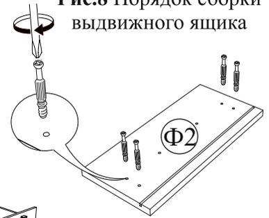
**Рис.9** Установка выдвигающего ящика
