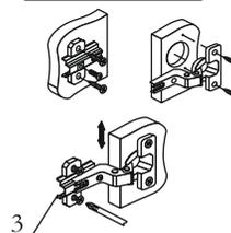
**Регулировка створки по глубине**
