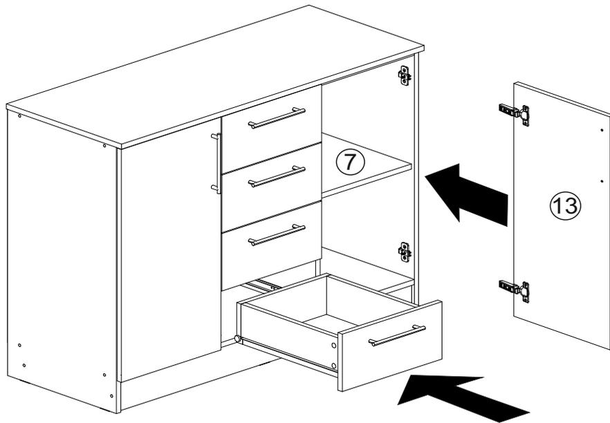
Установка и регулировка петель
