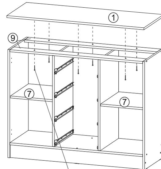
Крышку №1 закрепите с помощью шурупов 3,5x30 к Планкам №9 (планка используется для крепления ЛДВП)
