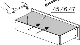
ДЛЯ УСТАНОВКИ НАПРАВЛЯЮЩИХ ИСПОЛЬЗУЙТЕ РЕГУЛИРОВОЧНЫЕ ОТВЕРСТИЯ, А ТАК ЖЕ ШУРУП 3.5Х16
