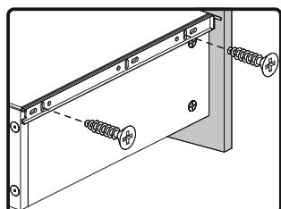
ДЛЯ СБОРКИ СТЕКЛОСТВОРКИ ИСПОЛЬЗУЙТЕ РОВНУЮ И ТВЕРДУЮ ПОВЕРХНОСТЬ В ГЛУХИЕ ОТВЕРСТИЯ НА ДЕТ. №38, 40 УСТАНОВИТЕ ПЛАСТИКОВУЮ ФУТОРКУ
