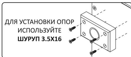
ДЛЯ УСТАНОВКИ ОПОР ИСПОЛЬЗУЙТЕ ШУРУП 3.5X16
