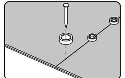
В МЕСТАХ СТЫКА ЛДВП ИСПОЛЬЗУЙТЕ ГВОЗДИ И ПЛАСТИКОВУЮ ШАЙБУ
