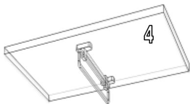
С помощью петель и шурупов 3,5\*16 установить и закрепить фасады 7 к боковинам 1.
