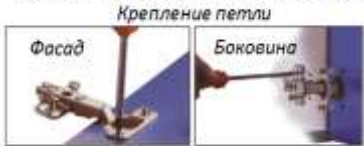
Схема установки и регулировки петли
