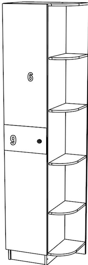
*Совместить готовые отверстия на фасаде с отверстиями на МДФ панели (предварительно снять защитную ленту с двустороннего скотча на панели МДФ), стянуть ручками.*
