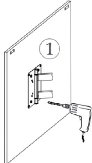
Расстояние между креплениями на телевизоре меряется измерительным инструментом (на самом кронштейне под ТВ есть эти отверстия), затем сверлите сквозь кронштейн под ТВ панель ЛДСП под свое крепление. Винты для крепления телевизора в комплект фурнитуры не входит.
