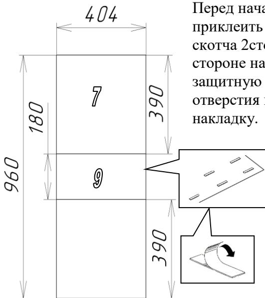
Перед началом сборки изделия, необходимо приклейте накладку 9 к фасаду 7 с помощью скотча 2стороннего (скотч приклеен на обратной стороне накладки). Для этого необходимо снять защитную плёнку со скотча, совместить отверстия на накладке и фасаде и прижать накладку.
