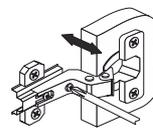
Регулировка створки по глубине
