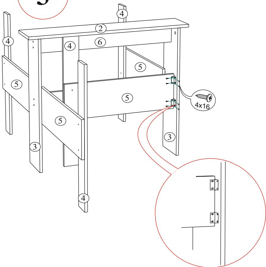
Прикручиваем опоры для стола к основанию стола с помощью карточной петли.
